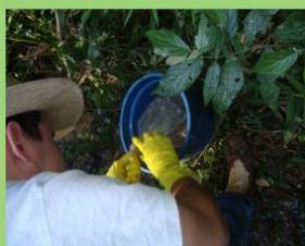
Figura 4. Transferindo a amostra para o saco plástico
